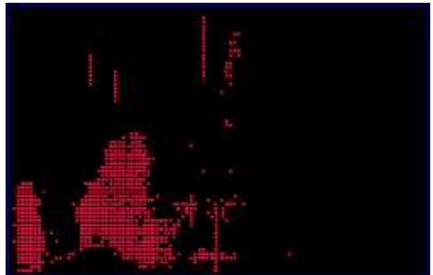
Bild 7.11: Lage der QZH-Berechnungsmodule im FPGA.
