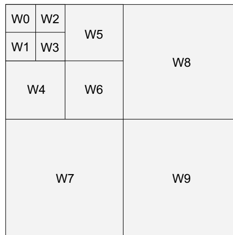
Bild 2.7: Bearbeitungsreihenfolge der Wavelet-Datenblöcke in der Quantisierung.
