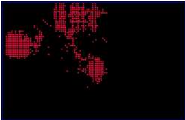
Bild 7.10: Lage der Wavelet-Berechnungsmodule im FPGA.
